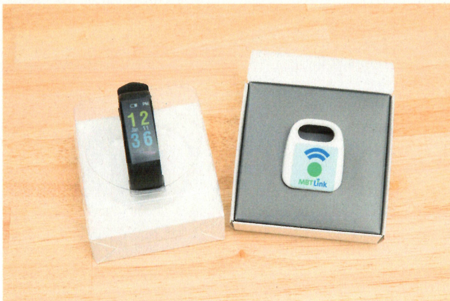
今回のサービスで用いる腕時計型ウェアラブル端末（左）と環境センサー（右）
